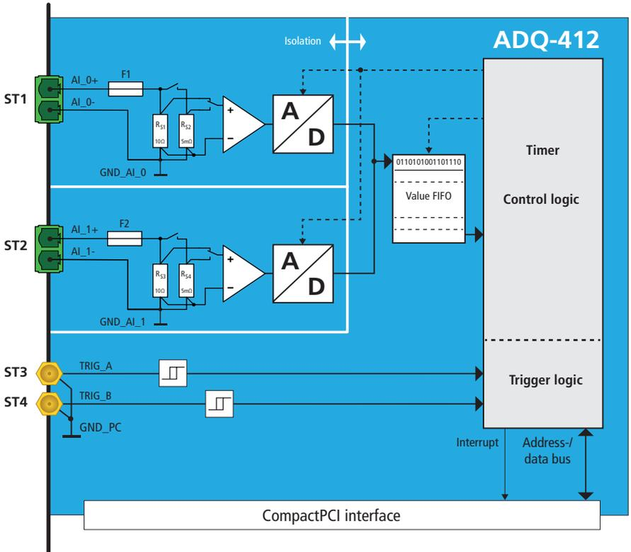
Figure 3: Block diagram ADQ-412
