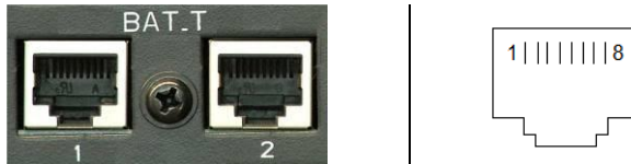
Abb. 5-12 PIN-Belegung und Zählrichtung der BAT_T Schnittstelle (RJ45).
