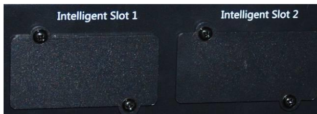
Abb. 3-18 Adapter-Einschübe zur Aufnahme der intelligent Erweiterungskarten (Anlagenvarianten 30 / 40 kVA).
