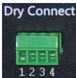
Abb. 5-11 Ausführung und Belegung der Signal-Schnittstelle.
