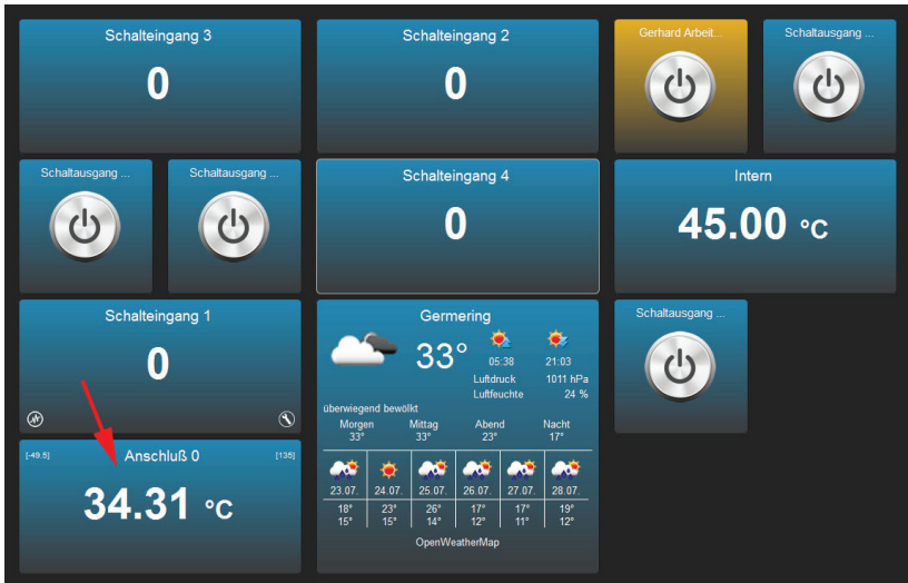
Abb. 74: Temperatursensor auf Hauptseite hinzugefügt
