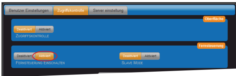
Abb. 34: Fernsteuerung im Remote-Gerät einschalten
