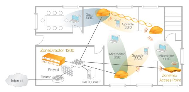
Der ZoneDirector 1200 kann an jeder beliebigen Stelle innerhalb eines Layer 2/3-Netzwerks installiert werden. Alle ZoneFlex Access Points erkennen den ZoneDirector automatisch und werden automatisch aktiviert und integriert.
